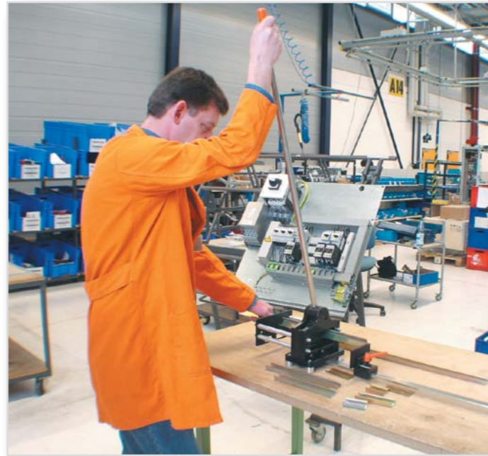
Направляющее устройство для точной резки под углом 90°
